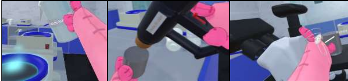
Figura 8. De izquierda a derecha: pulido, ataque químico, y colocación en microscopio.
