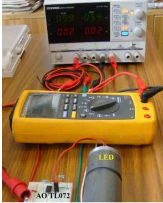
Figura 3.4. Arreglo experimental para obtener los voltajes de operación V_f en función de la corriente de operación I_f de cada LED con diferente longitud de onda.
