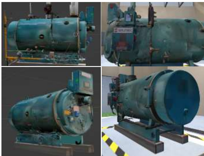
Figura 1. Modelo de la caldera con la técnica de fotogrametría, a la izquierda en el modelador (Blender), y a la derecha en el motor gráfico ya montado el objeto en un ambiente que incluye piso, paredes, y marcas de seguridad.
