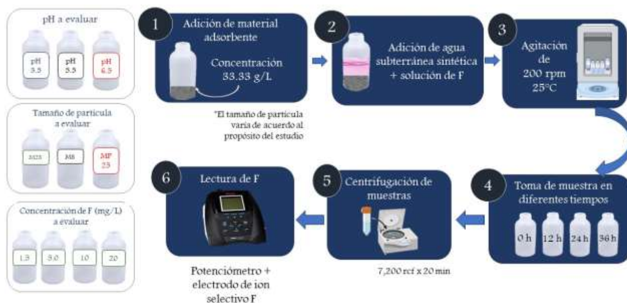
FIGURA 1. ESQUEMATIZACIÓN DE PRUEBAS PARA EVALUAR EL EFECTO DE pH, TAMAÑO DE PARTÍCULA Y CONCENTRACIÓN INICIAL DE F SOBRE SU REMOCIÓN EN AGUAS SUBTERRÁNEAS SINTÉTICAS.
