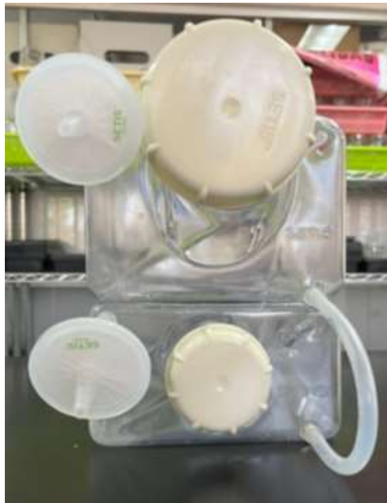
FIGURA 1: BIORREACTOR DE INMERSIÓN TEMPORAL TIPO SETIS, DONDE EL RECIPIENTE SUPERIOR Y DE MAYOR TAMAÑO ES DESTINADO PARA EL MATERIAL VEGETAL Y EL INFERIOR PARA EL MEDIO DE CULTIVO LÍQUIDO.
