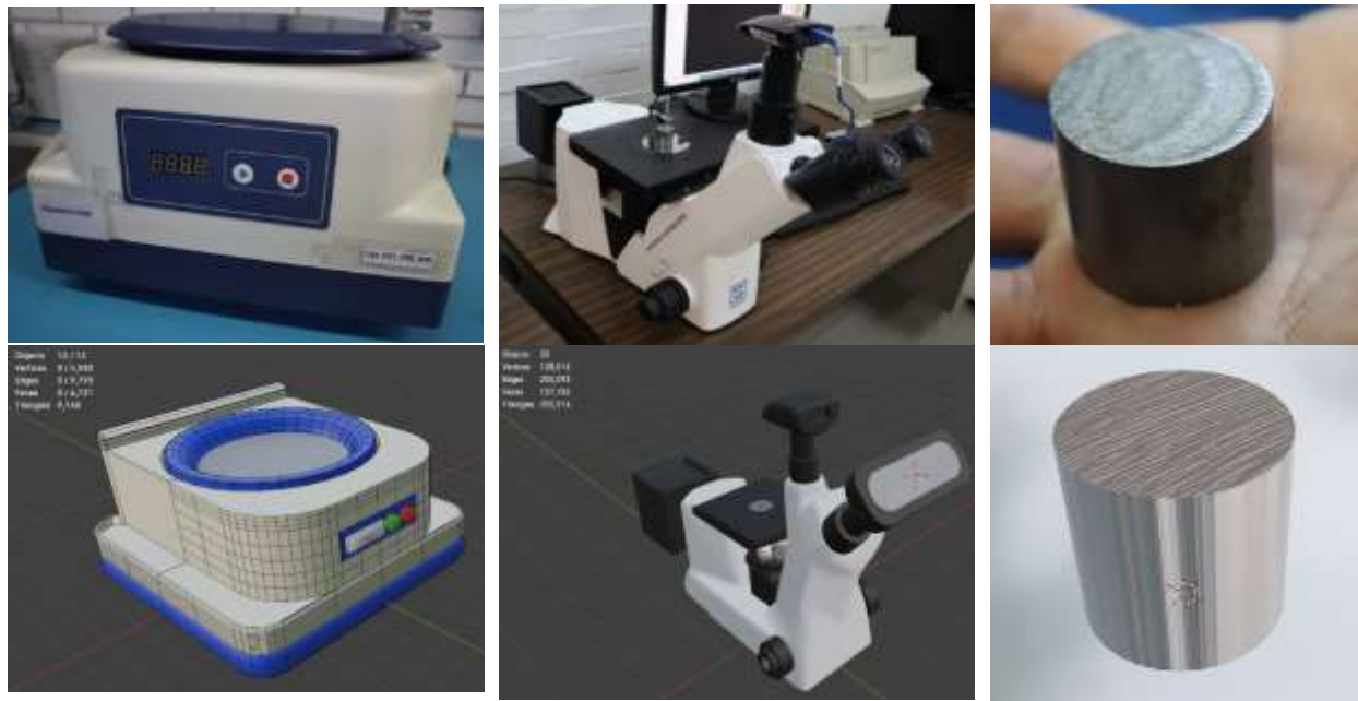
Figura 2. De izquierda a derecha, en la parte superior la desbastadora, microscopio, y probeta del laboratorio real, en la parte inferior sus modelos virtuales.
