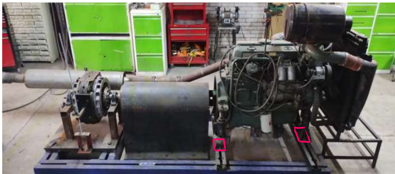
Figura 8. Dinamómetro de banco para motores de hasta 500 hp. El rectángulo rojo representa la superficie de unión de las torres de nivelación y los largueros.
