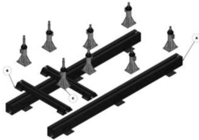
Figura 1: Primera iteración del chasis inferior, siendo A largueros, B travesaños y C torres de nivelación
