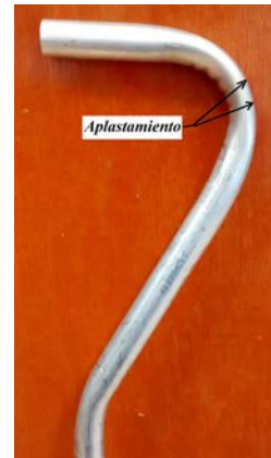
Fig. 4. Aplastamiento del tubo extruido
