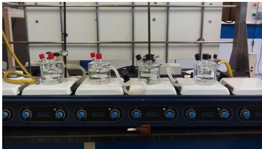
Figura 1.- Dispositivo experimental por lotes utilizando un recirculador para mantener una temperatura constante.
