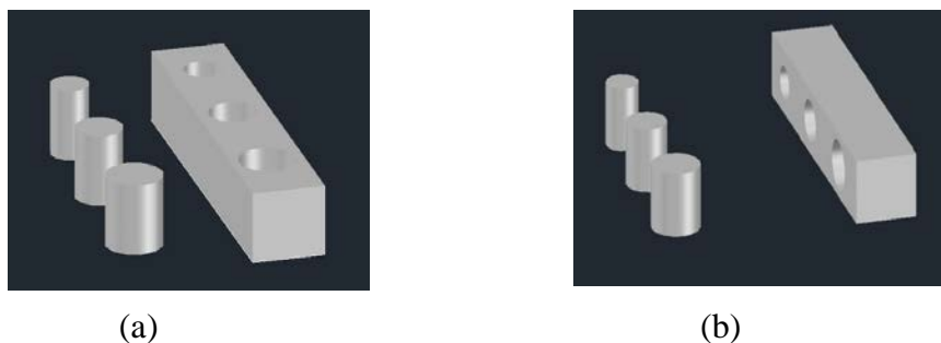
Fig. 1.- Testigos extraídos en dirección paralela (a) y perpendicular (b) al vaciado
