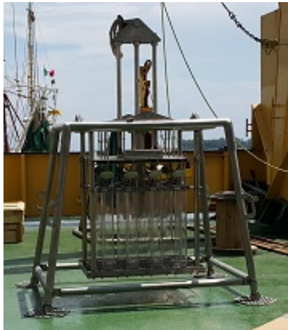
Figura 3: Multinucleador de 8 tubos para muestreo de lecho marino blando. (Foto: Rigoberto Nava).
