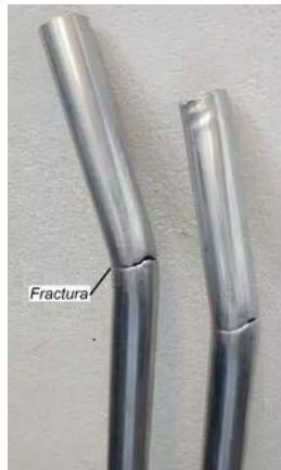
Fig. 3. Fractura del tubo calibrado
